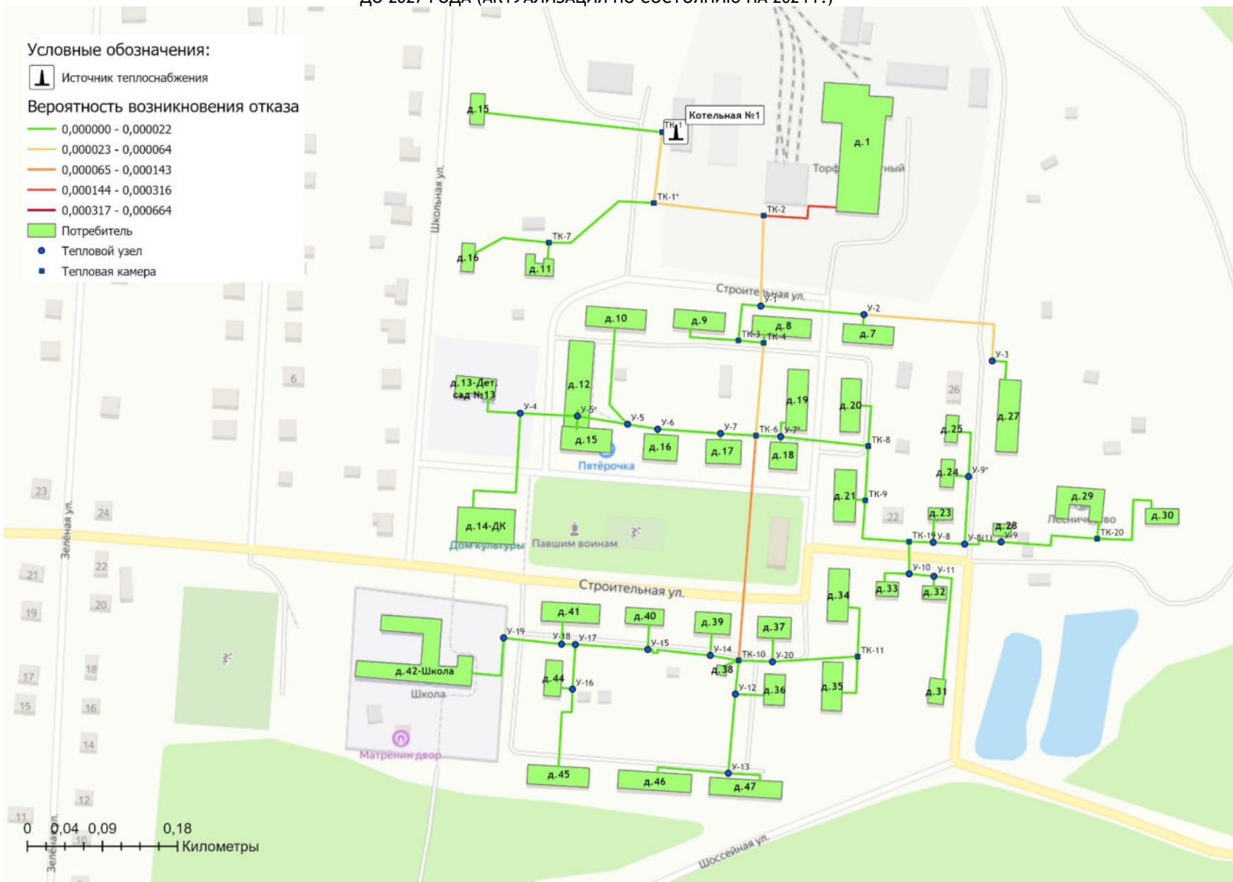
Рисунок 1.9.4.1 - Карта-схемы тепловых сетей и зон ненормативной надежности и безопасности теплоснабжения от котельной пос. Мезиновский №1
