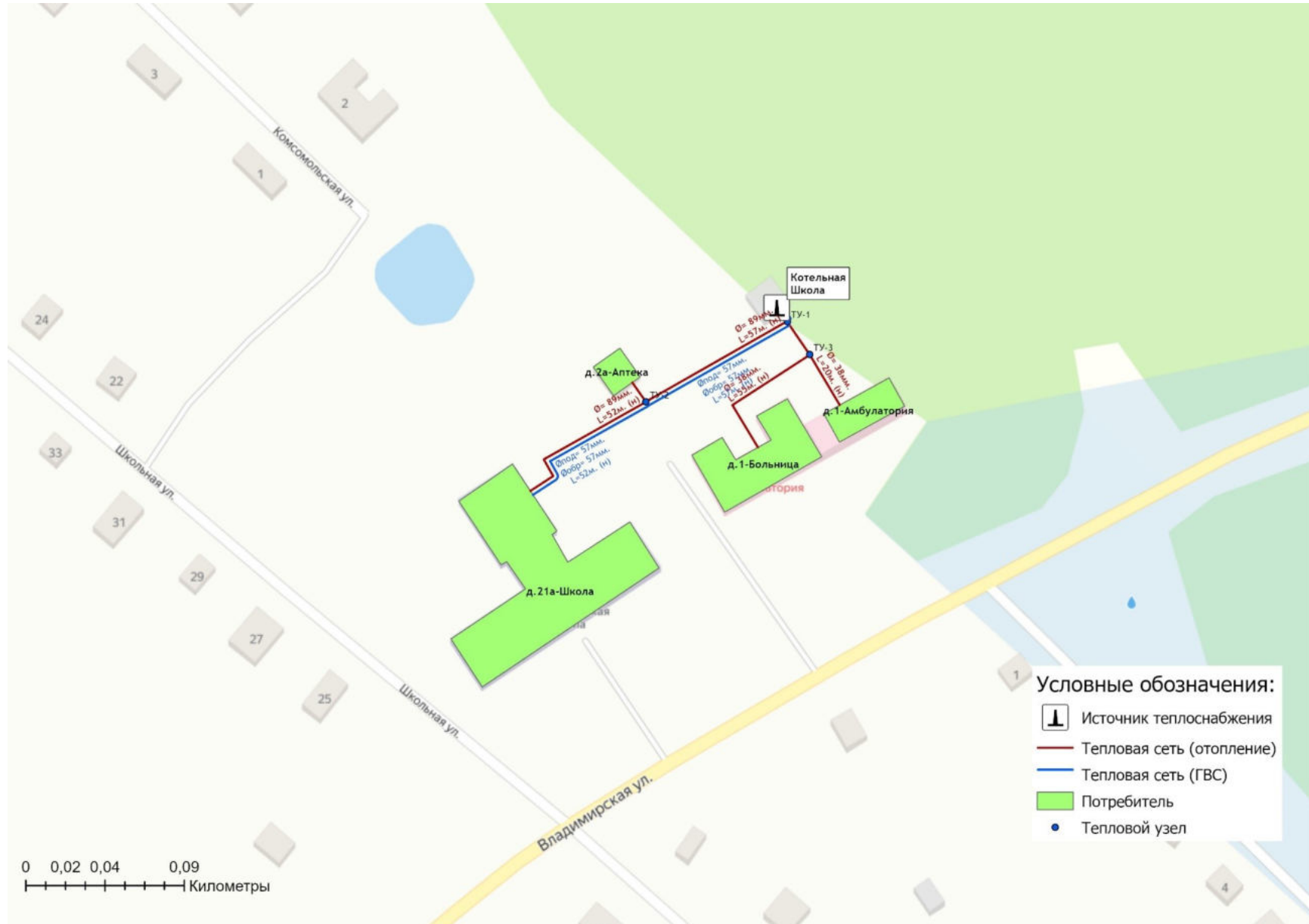
Рисунок 1.3.1.1 - Схема тепловых сетей отопительной котельной пос. Иваньци
