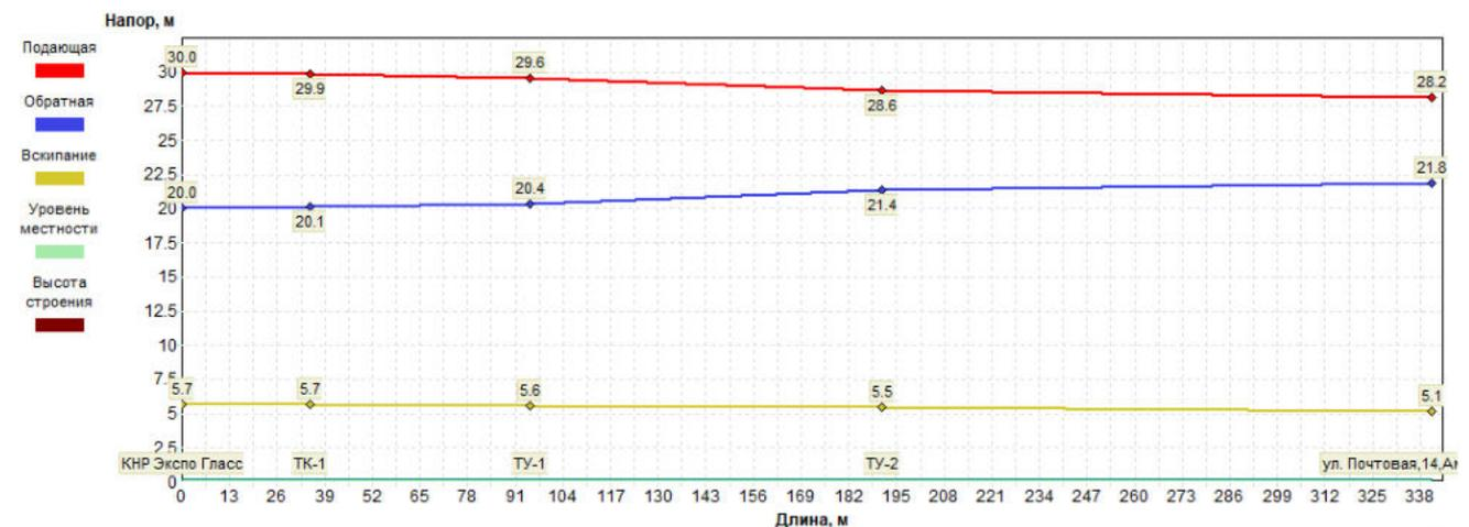
Рисунок 1.3.7.2 - Пьезометрический график от котельной КНР ООО «Экспо Гласс» до здания амбулатории (ул. Почтовая, д.14)
