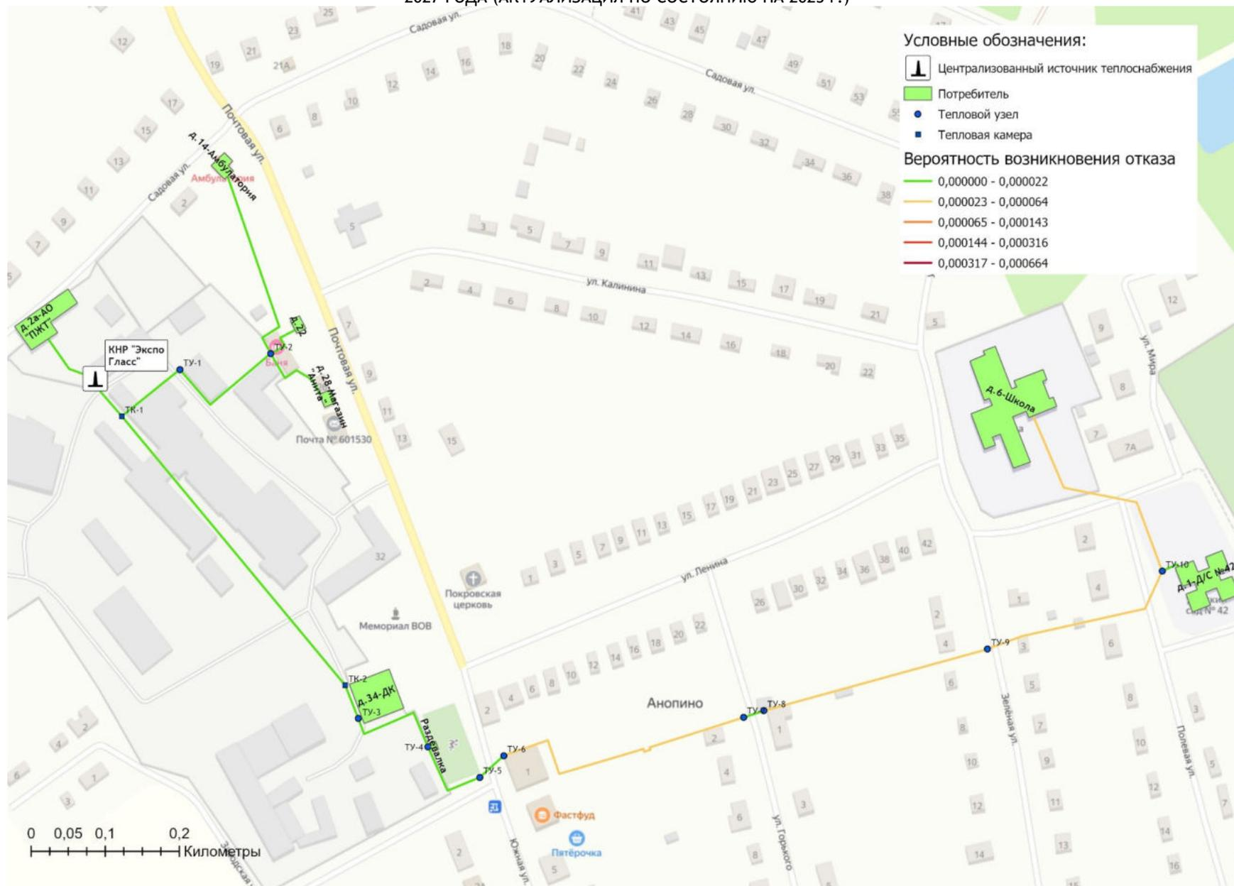
Рисунок 1.9.4.1 - Карта-схемы тепловых сетей и зон ненормативной надежности и безопасности теплоснабжения от котельной КНП ООО «Экспо Гласс»
